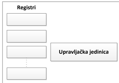
Slika 6: Blok šema kontrolera
