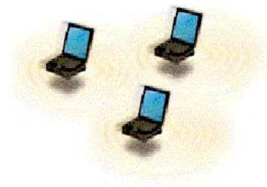
Слика 13.3 Ad hoc начин међусобног повезивања рачунара
