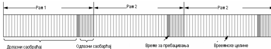
Слика 3.19 Додељивање временских целина рамовима код система са временским дуплирањем
