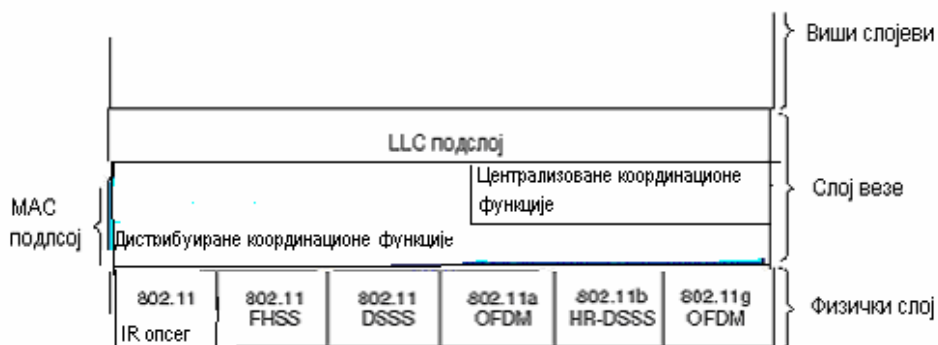
Слика 13.6 Слојевита архитектура протокола у бежичним локалним рачунарским мрежама
